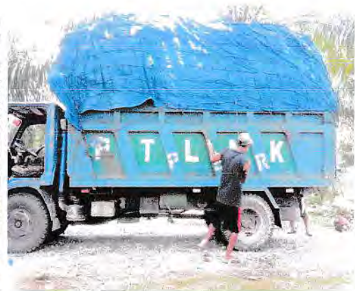
Gambar 14. Proses Persiapan TBS Untuk dibawa ke PKS mulai dari penutupan dengan terpal, jaring, dan dirantai keliling
