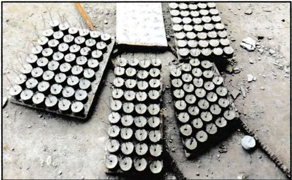
Gambar 4. Beton decling (Tahu Beton)
