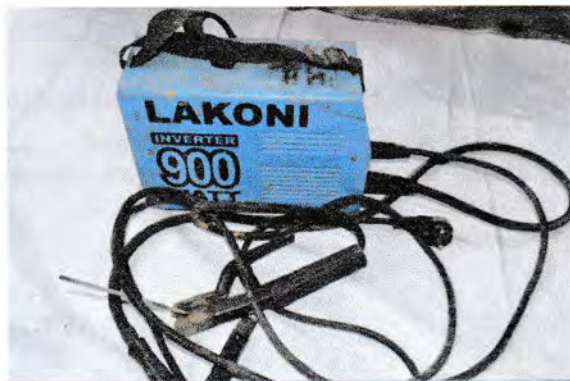
Gambar 3.3 Trafo Las listrik.
