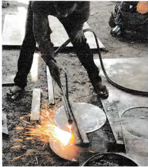
Gambar 4.5 Proses pemotongan pelat mesin pencacah pelepah kelapa sawit
