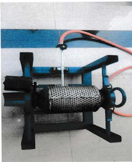
Gambar 4.2 hasil rancang bangun alat sangrai kopi
