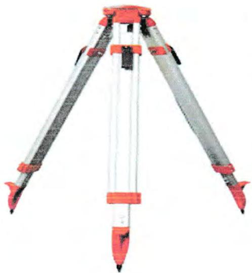
Fungsinya sebagai tempat untuk meletakkan alat waterpass atau theodolite
