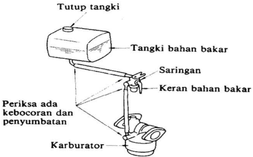
Gambar3.3 Komponen Sistem Bahan Bakar pada Motor Bensin
