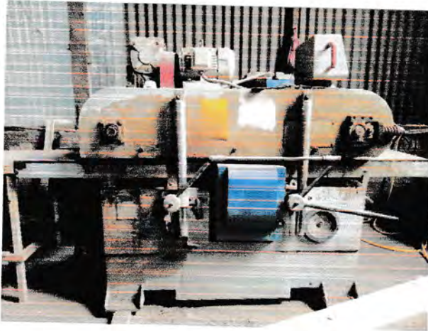
Gambar 3.6. Mesin Auto Side
