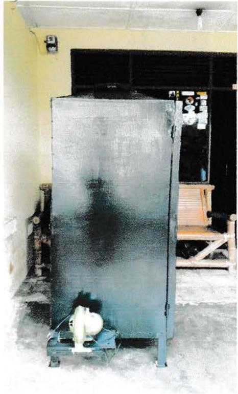
**Gambar bagian luar mesin pengering bawang**
