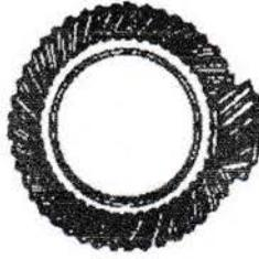
Gambar. 2.7. Roda gigi kerucut spiral
