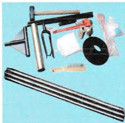
**Gambar IV.3 Perlengkapan Sondir**
