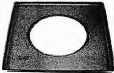
Gambar 4. Plat Untuk Corong Lubang Dibagian Tengah D16,5 Cm
