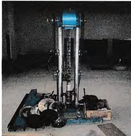
**Gambar IV.1 Mesin Sondir**
