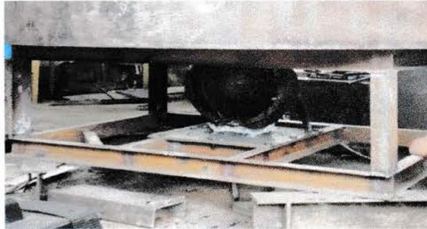
Gambar 3.4. Perakitan mesin mixer batako
