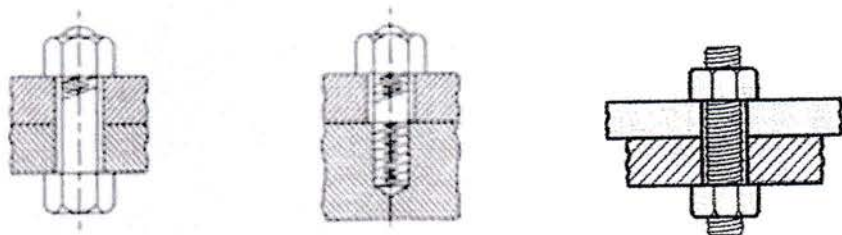
Gambar 2.18 Prinsip kerja baut
