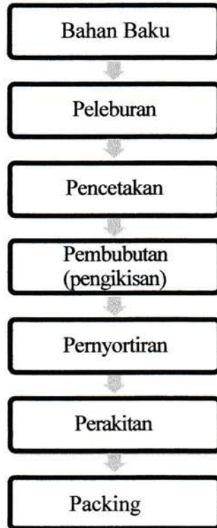
Gambar.3.1. (Bagan struktur proses produksi)
