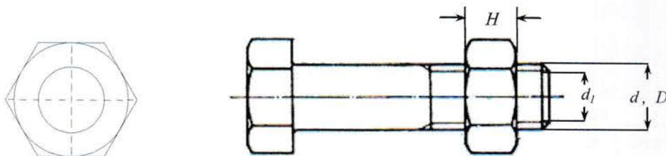
Gambar. 3.6. Baut dan Mur
