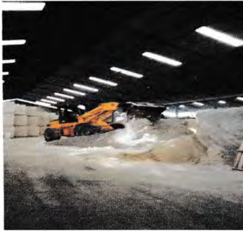
Gambar 3.7. Pengadukan Bahan dengan Alat Berat Wheel Loader
