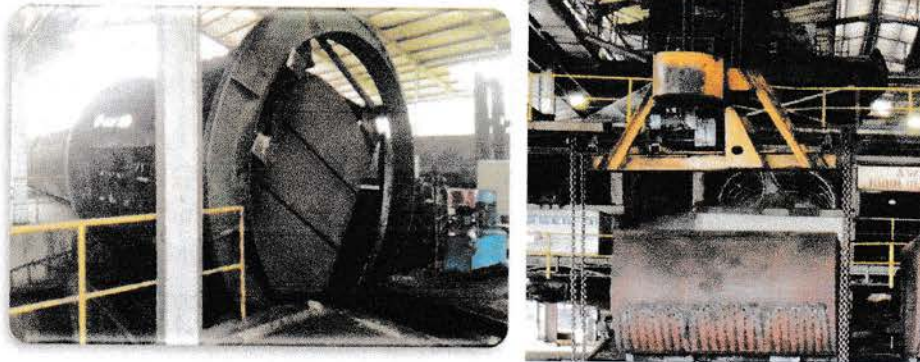
Gambar 3.11 Hoisting Crane dan Tippler
