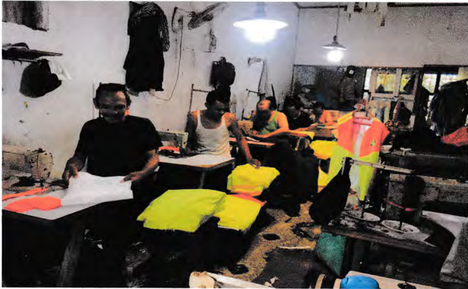
Gambar 3.8 Proses Penyatuan Pola-Pola Design Yang Sudah Di Cutting
