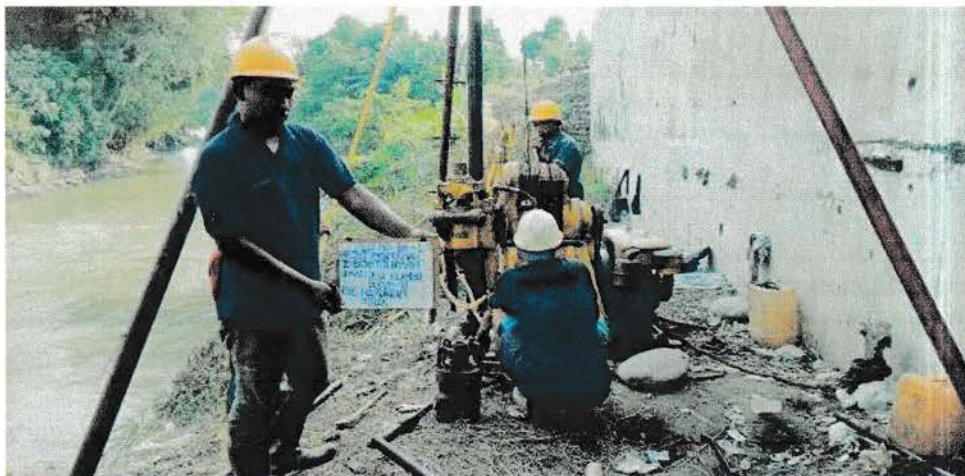
Gambar 3.18. Cara Kerja Alat Sondir Elektrik
