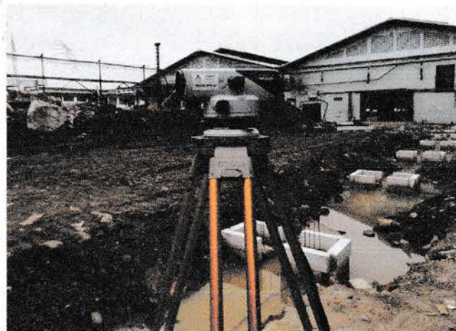
Gambar 3.2 Waterpass Sumber : data lapangan
