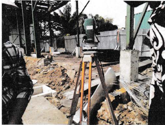
Gambar 3.1 Theodolite Sumber : data lapangan
