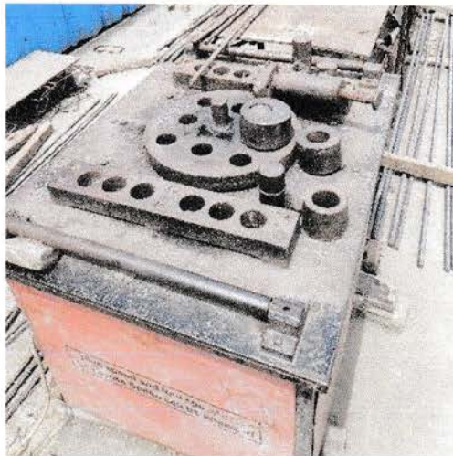
Gambar 3.5 Bar Bender Sumber : data lapangan
