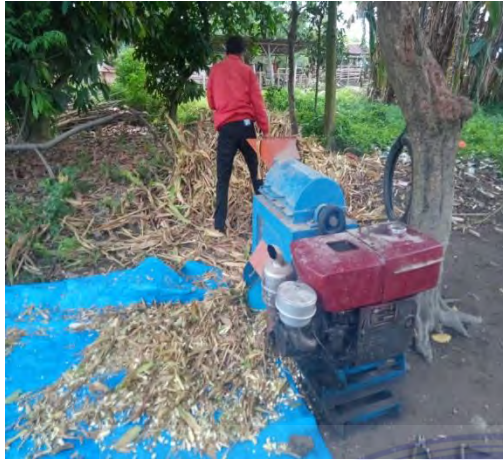
Gambar 1. Penggilingan limbah jagung
