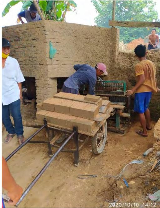
Gambar 6 : Proses pembuatan Batu-bata menggunakan mesin cetak
