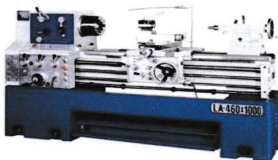
Gambar 3.9 Mesin Bubut *Centre Lathe*
