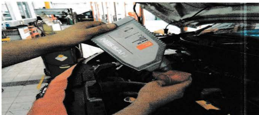
Gambar 3.20. Proses Pengisian Oli Transmisi
