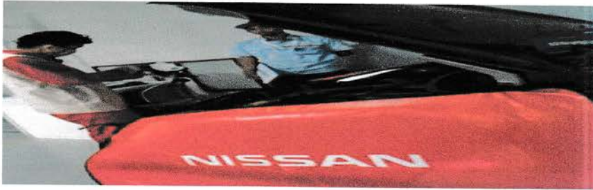
Gambar 3.15. Pemasangan Fender Cover.
