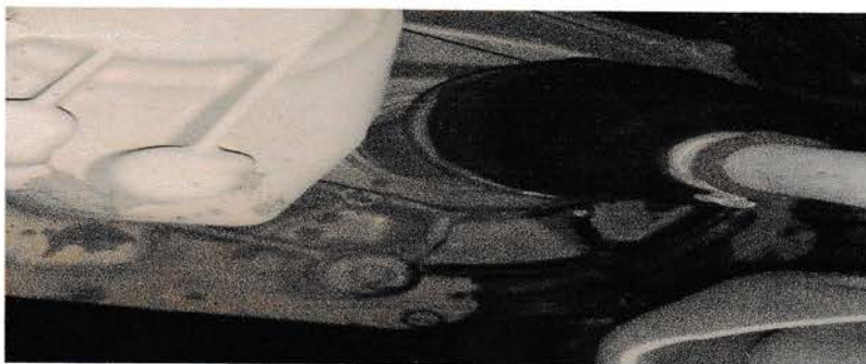
Gambar 3.19. Baut Drain Plug Sudah Tertutup
