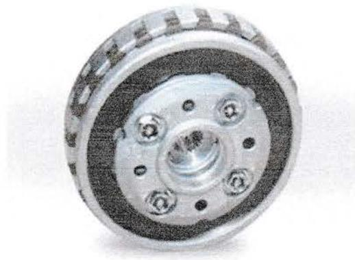
Konstruksi kopling terdiri dari berbagai plat gesek yang berputar, untuk menggerakkan kopling, kedua plat penggerak dan yang digerakkan ditekan bersama oleh per (manual) untuk tipe otomatis oleh gerakan sentrifugal. Dalam perancangan kali ini kopling yang digunakan ialah kopling tipe piringan/disc dengan gerakan sentrifugal tipe otomatis.
