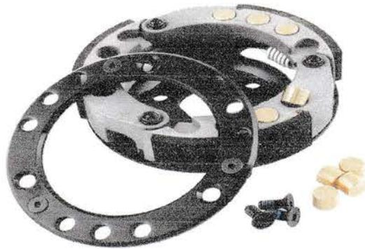
Sepatu penggerak keluar oleh daya sentrifugal sehingga sepatu tersebut berhubungan dengan drum(Housing).
