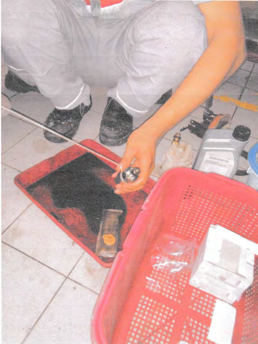
Gambar: 5.6 pembersihan saringan pompa
