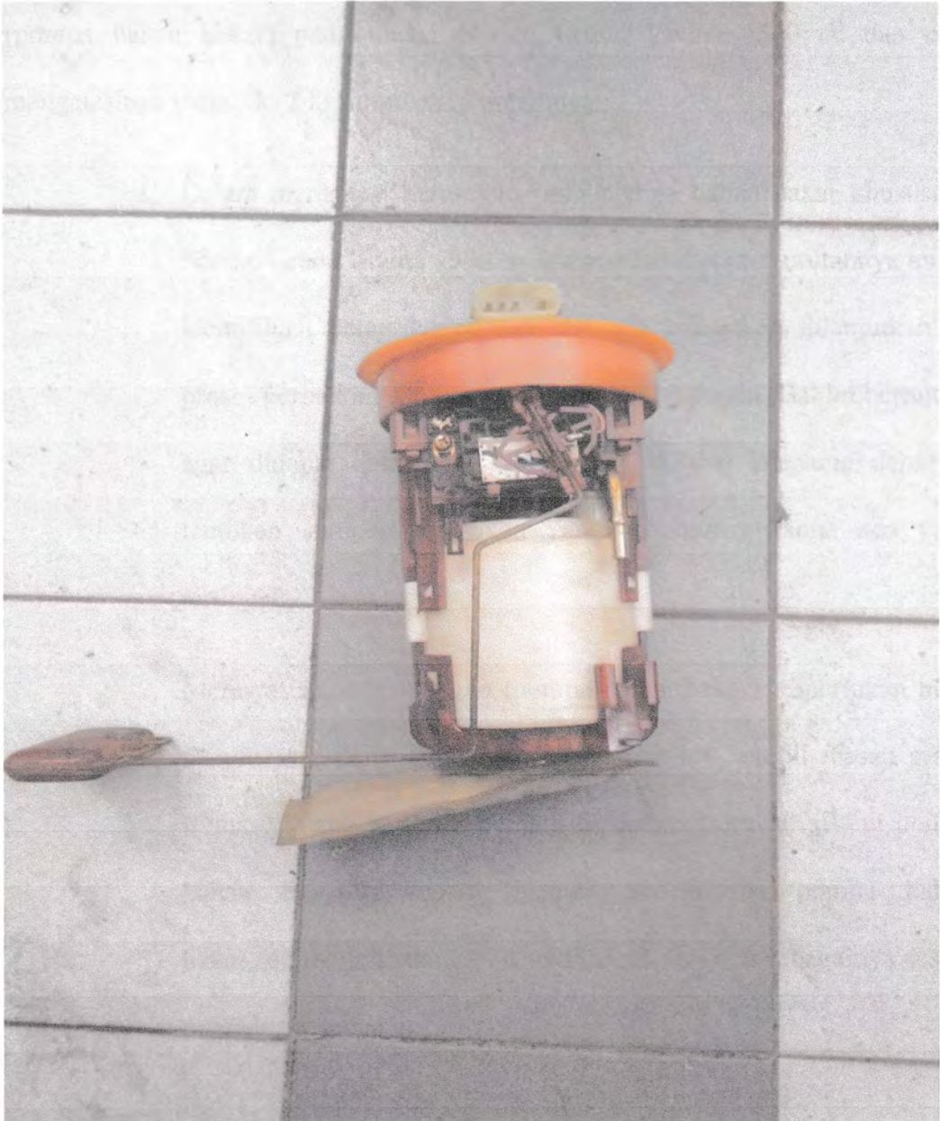
Gambar: 5.9 pompa bahan bakar yang telah siap di rakit
