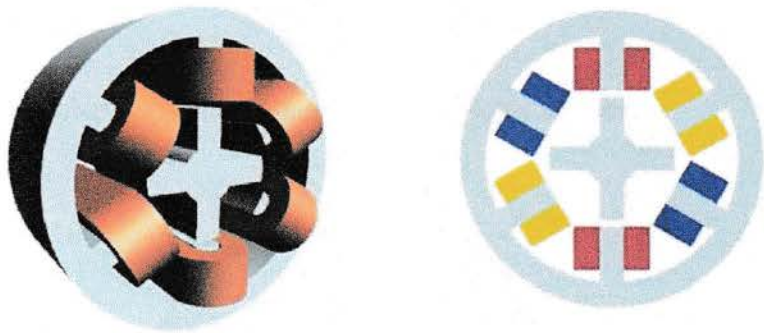
Gambar 4.7 Diagram 3D dan model 2D yang sederhana variable keengganan motor.
