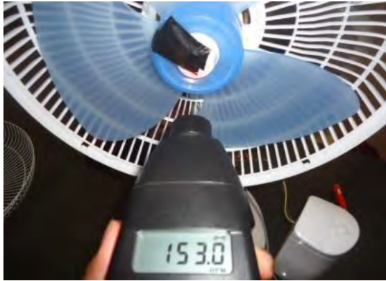
Gambar 4 Pengujian Pada Kecepatan Pertama
