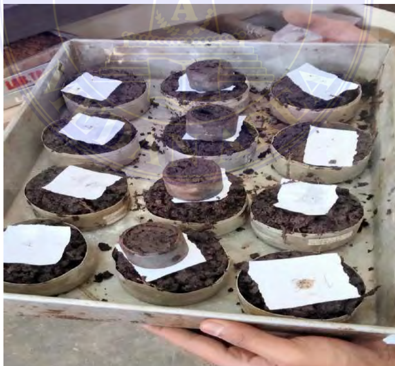
Proses Pengujian Kadar Air dan Berat Isi
