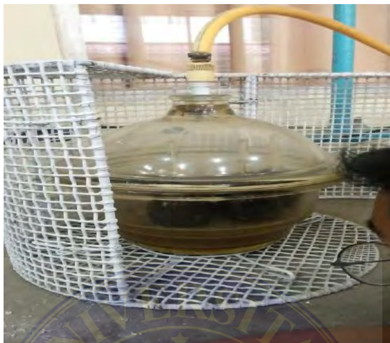
Proses Pengujian Berat Jenis Tanah di Dalam Desikator
