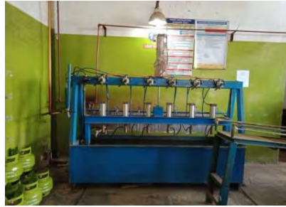
Gambar 6. Leak Test Akhir
