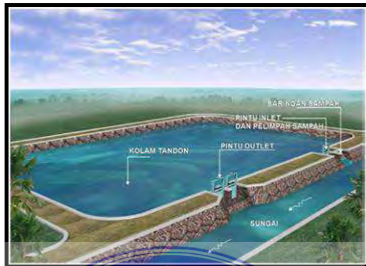
Gambar 2.9 Kolam Retensi Tipe di Samping Badan Sungai Sumber: Gilang Rupaka (2012)
