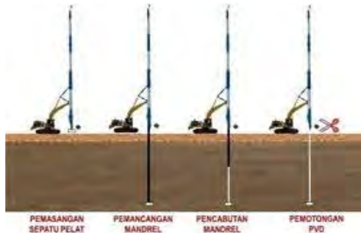
Gambar 2. 5. Tahapan pemasangan PVD kedalam tanah (sumber : pgsi.com)
