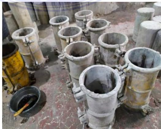
Gambar 3.2 Benda uji berbentuk silinder dengan ukuran 15cm x 30cm
