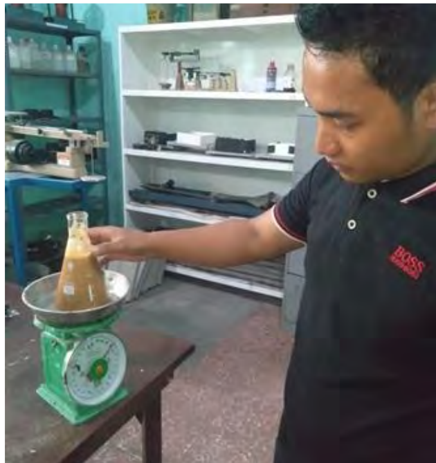
Menimbang piknometer yang berisi sampel tanah dan air pada uji berat jenis tanah
