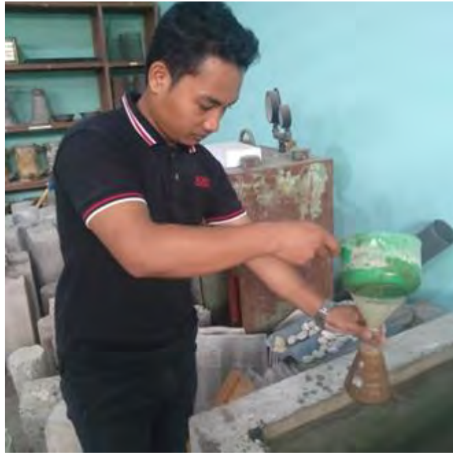
Memasukkan air kedalam piknometer yang sudah berisi sampel tanah pada uji berat jenis tanah
