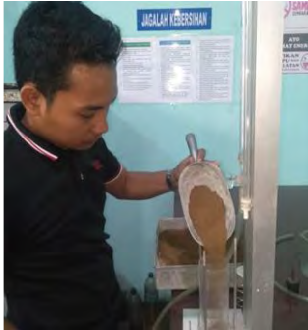
Memasukkan sample tanah ketabung benda uji permeabilitas
