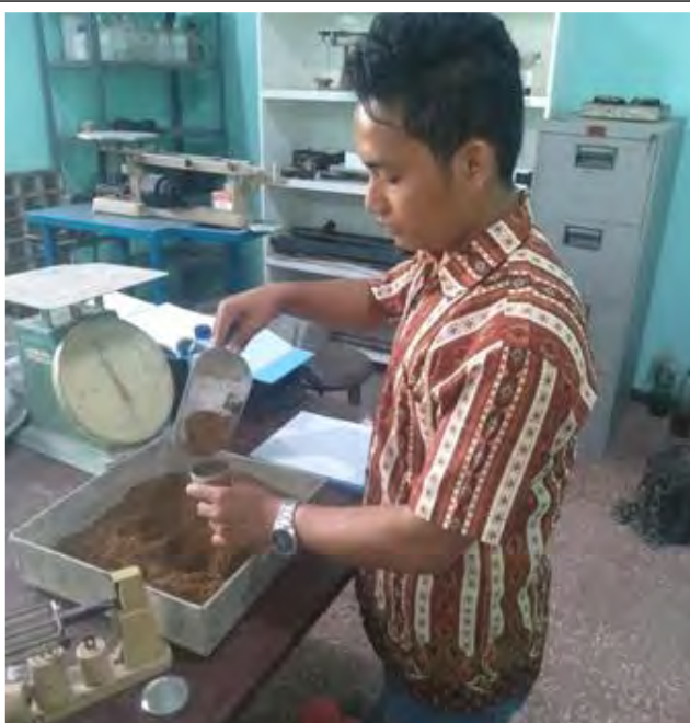
Memasukkan sampel tanah kedalam cawan pada uji berat kering / basah tanah
