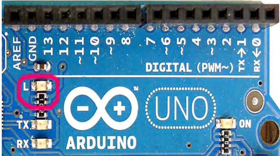
**Gambar 2.4: Led-led di Arduino**
