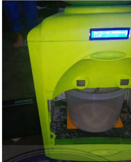
Gambar 3.19 Pengujian Berat Beras Yang Dikeluarkan Oleh Motor Servo Melalui Jarak Lima Meter
