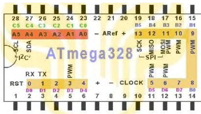
Gambar 2.4 Pin Mikrokontroler ATMega328
