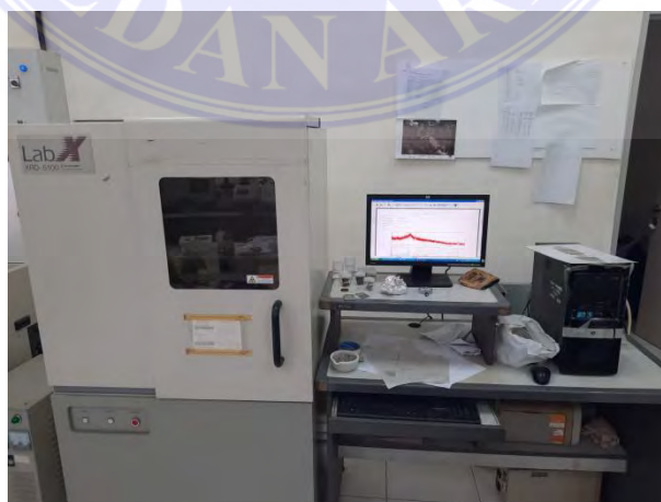
Gambar 10. Pengujian nanopartikel T. diversifolia dengan X-ray diffraction
