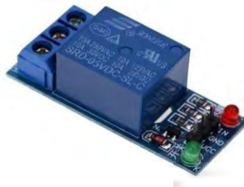
**Gambar 2.4 : Module Relay**
