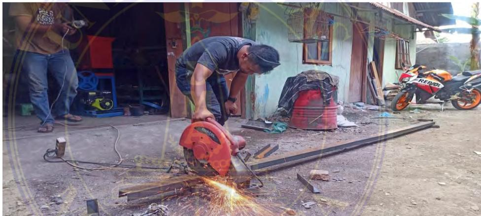
Gambar 2.17 Pemotongan menggunakan gerinda
