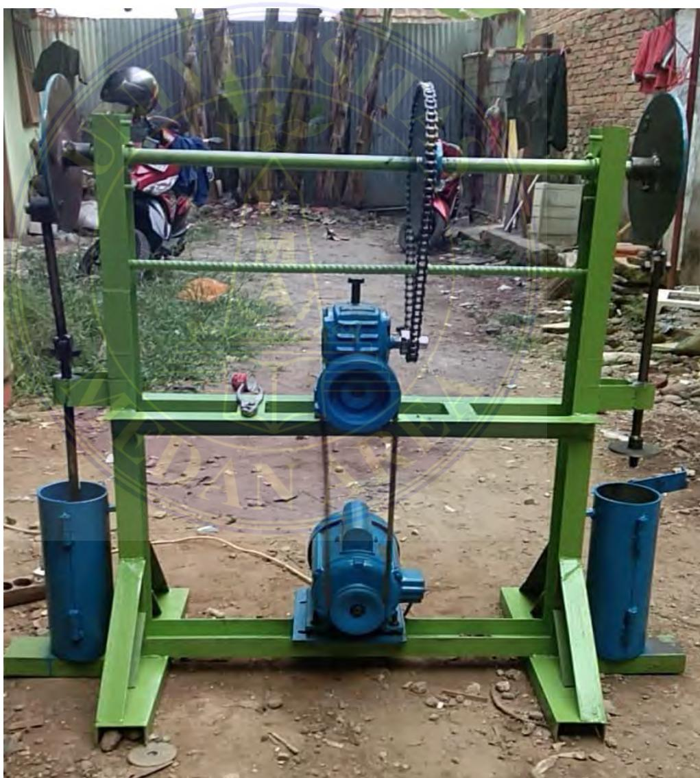
Gambar 4.2 Hasil rancang bangun alat press baglog jamur tiram dua silinder dengan penggerak motor listrik.
