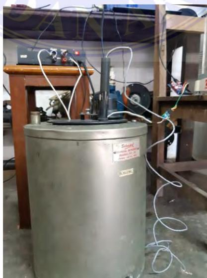
Gambar 3.4. Kalorimeter Bom
