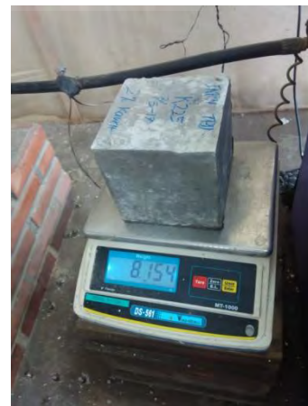
Penimbangan Benda Uji
