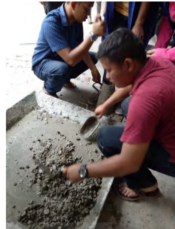
Memasukkan campuran dalam kerucut
