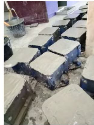
Benda uji ditunggu 24 jam
