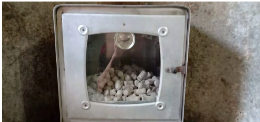
Lampiran 5. Proses pengeringan biopelet menggunakan oven.
