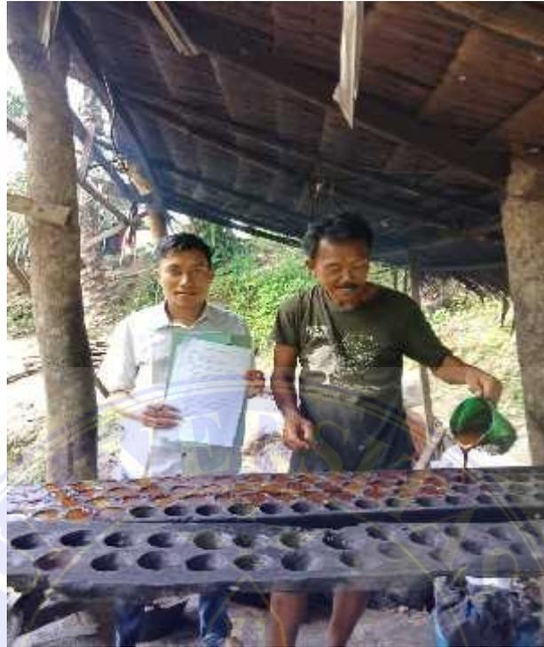
Gambar 6. Proses Pencetakan Gula Merah Dengan Cetakan Kayu
