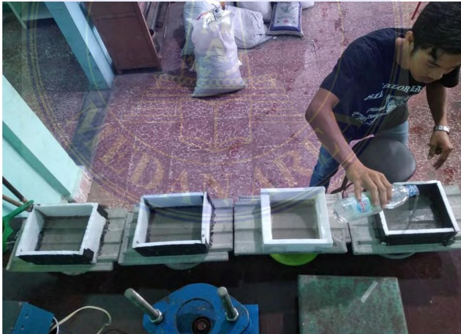
Gambar: Penuangan air kedalam wadah yang telah dibuat di bagian Atas genteng dan didiamkan selama 24 jam.
