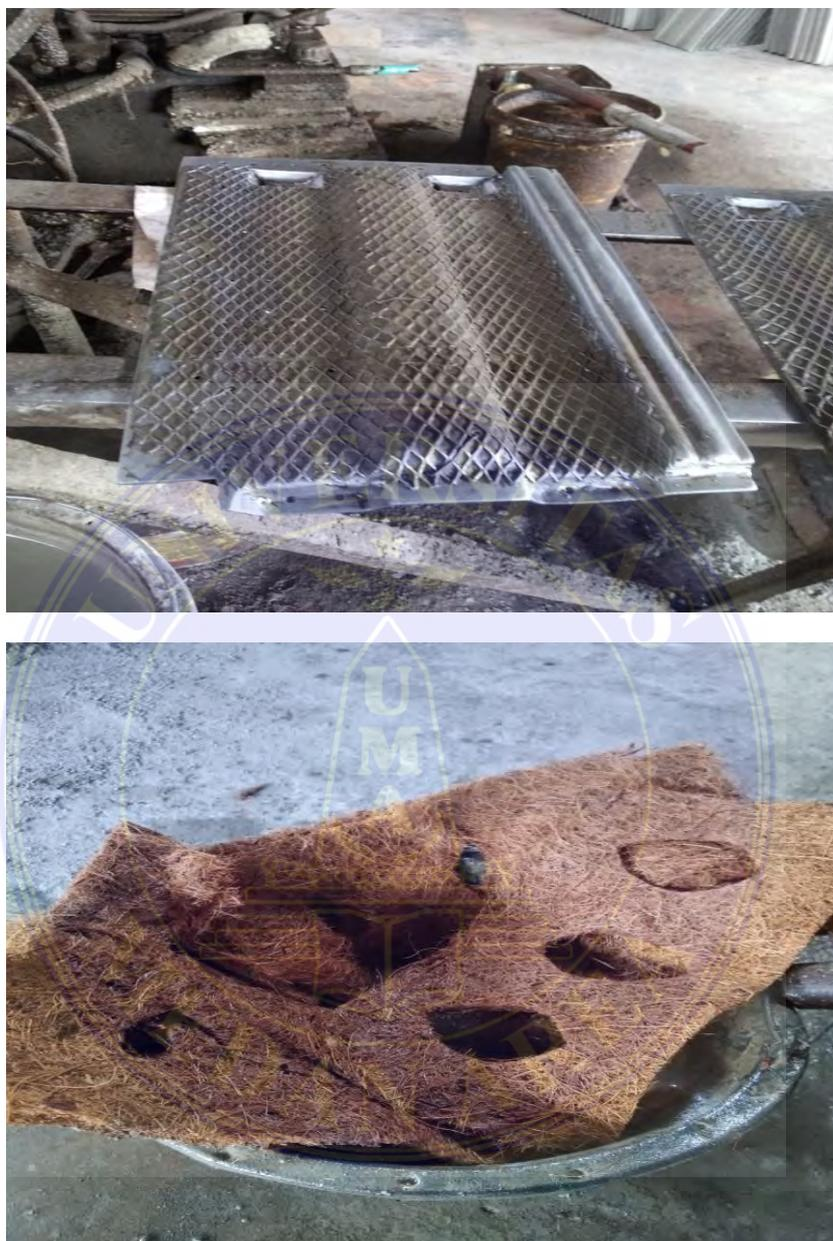
Gambar: persiapan serabut kelapa yang akan di tambahkan pada pembuatan genteng.
