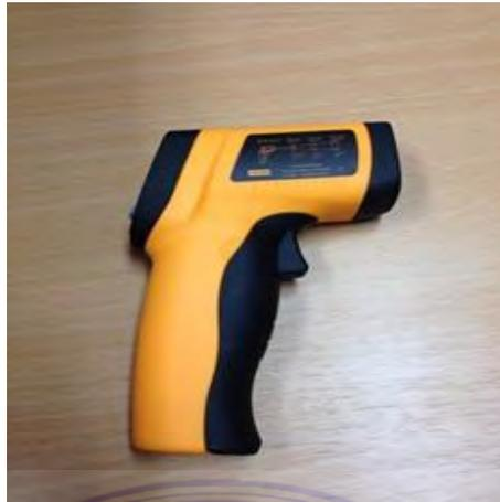
Gambar 2. 6 Thermometer Infra Merah.
