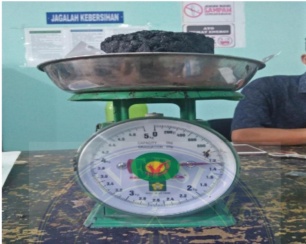
Gambar 9. Proses pengukuran berat aspal yang sudah di tumbuk
