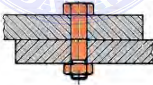
Gambar 2.9. Sambungan Mur dan Baut.
