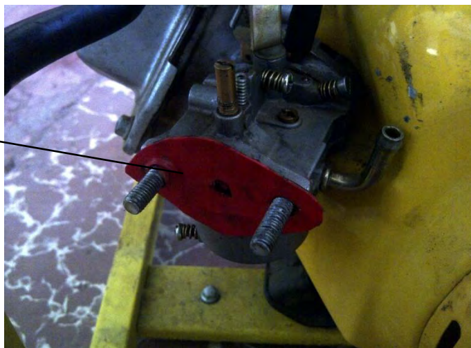
Gambar 2.19 Paking tambahan sebagai penutup mulut karburator
