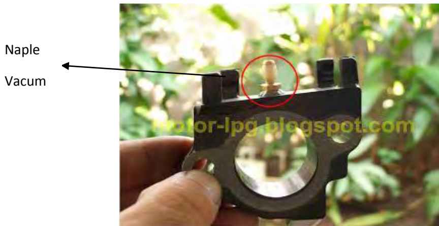
Gambar 2.11 Gambar niple vacum terpasang pada isolator karburator
