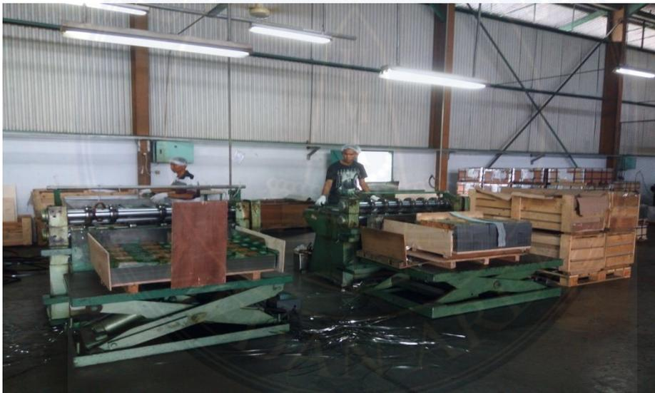
Gambar 2 orang karyawan bagian sliter yang sedang melakukan proses produksi, yang fungsinya untuk memotong material kaleng
