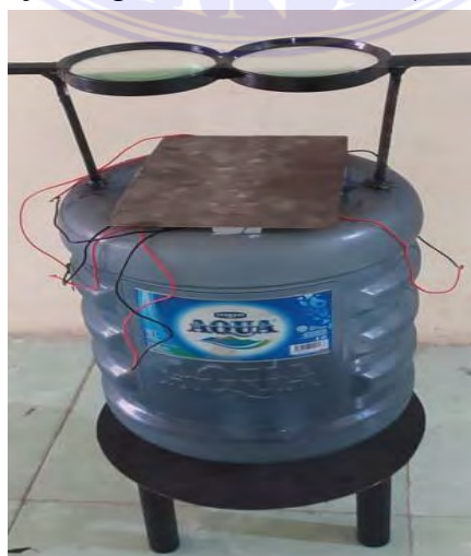
Gambar 3.20. Rancangan Alat Uji Penelitian Menggunakan Plat Baja.
